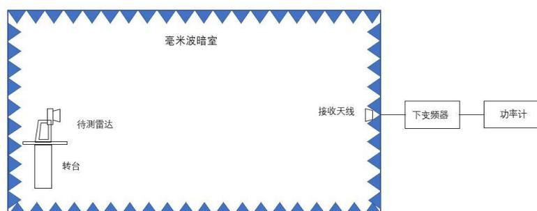
图 B.2 发射测试暗室
