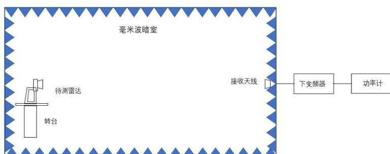
图 B.2 发射测试暗室
