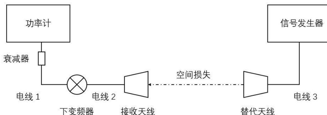
图 C.1 校准装置
